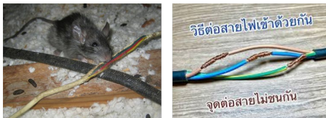
รูปที่ 105 สายไฟขาดชำรุดจากถูกสัตว์กัดแทะหรืออุบัติเหตุต่างๆ
