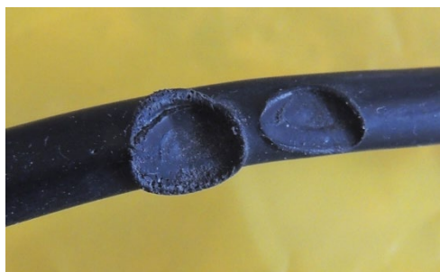
รูปที่ 106 สายไฟขาดชำรุดจากถูกสัตว์กัดแทะหรืออุบัติเหตุต่างๆ
