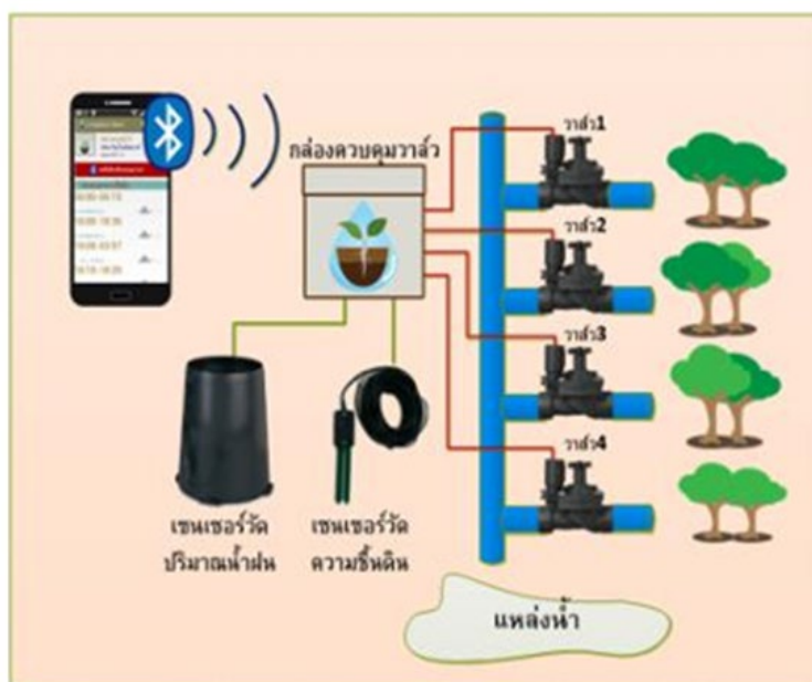
รูปที่ 55 การแสดงระบบรดน้ำอัตโนมัติตามความชื้นดิน
