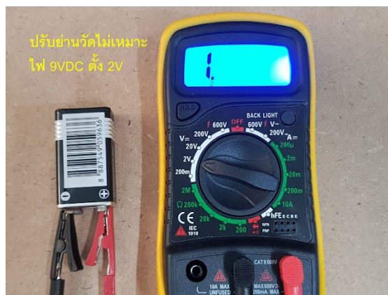
รูปที่ 88 การวัดแรงดันไฟ VDC ด้วยมัลติมิเตอร์ดิจิทัล
