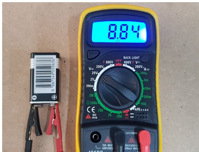
รูปที่ 85 การวัดแรงดันไฟ VDC ด้วยมัลติมิเตอร์ดิจิทัล
