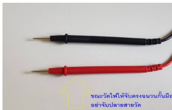
รูปที่ 89 การวัดแรงดันไฟ VDC ด้วยมัลติมิเตอร์ดิจิทัล
