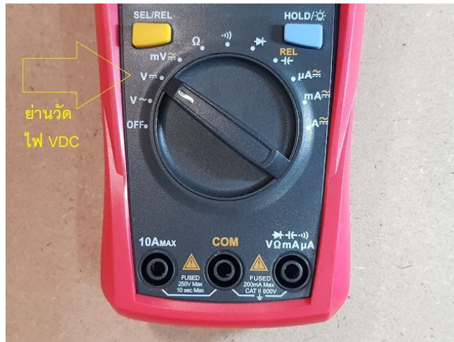
รูปที่ 84 การวัดแรงดันไฟ VDC ด้วยมัลติมิเตอร์ดิจิทัล
