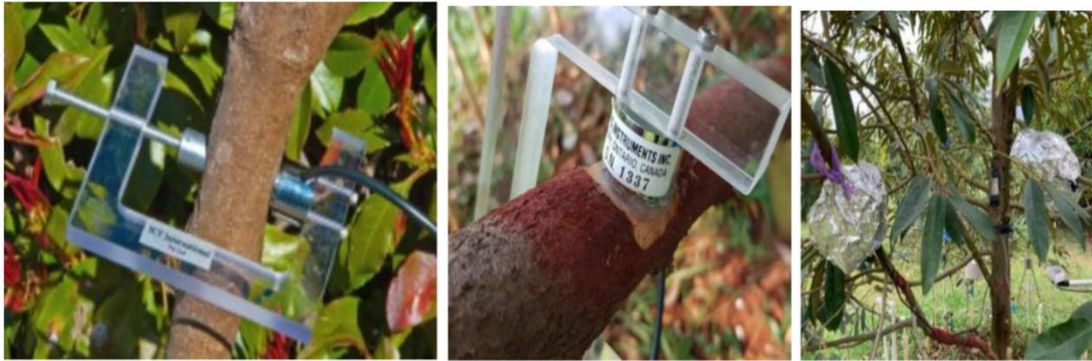
การติดตั้งเพื่อตรวจวัดการดูตุน้ำและการคายน้ำของพืช
