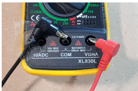
รูปที่ 83 การวัดแรงดันไฟ VDC ด้วยมัลติมิเตอร์ดิจิทัล
